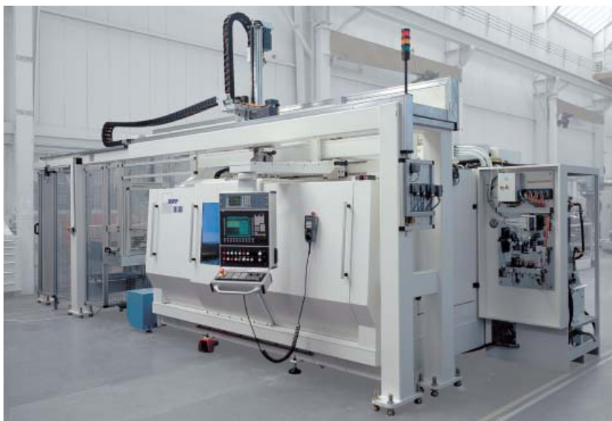
SN 306 型磨床，带龙门型装卸料机构，用于系列生产
