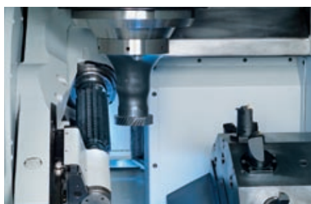
VSC 400 WF 齿轮的车削和滚齿设备
