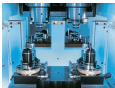
VSC TWIN 系列 用于加工盘类件的倒置式多主轴机床， 可同步加工两个工件
