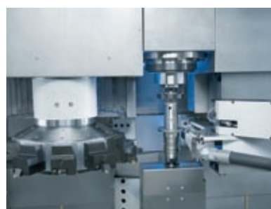
VTC 315 DS 用于加工轴类件的立式 车磨中心
