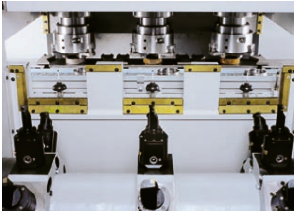
三个测量头同时测量
