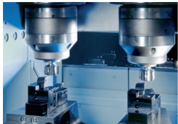
VSC 160 TWIN 型机床：两个主轴安装了相同刀具
